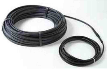
Heizband Dachrinne selbstregulierend 2m 230V 18W/m Beispielfoto
